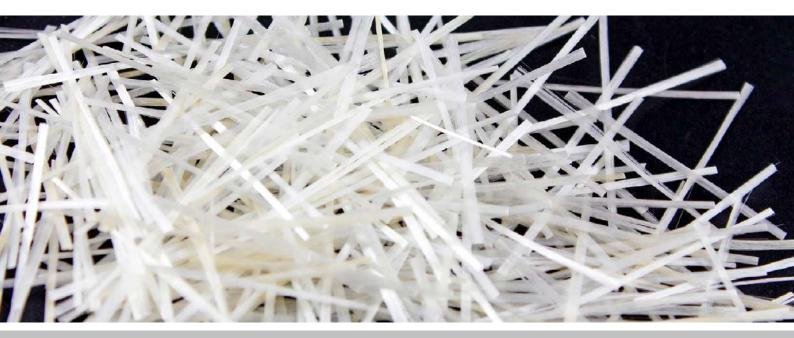
Fibra de vidrio álcali resistente. Complemento de morteros y hormigón para aumentar su resistencia y reducir la fisuración
