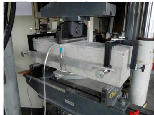
Imagen de la prueba de flexión de 3 puntos según norma NBN EN 14651+A1 (2007), de hormigón reforzado con 4 Kg/m 3 de POLIFIB TORSIONADA 50/25 .
